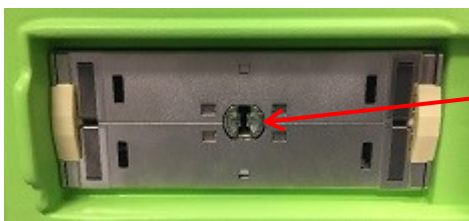
7. ábra: A transzducer-csatlakozóaljzaton lévő reteszelőnyílás
